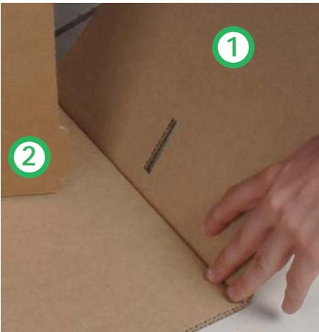
Positionner le renfort vertical dans l'encoche de la pièce n°1
